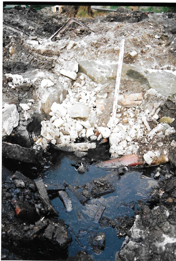
Foto 9: Neben dem ersten Ölschacht wurde ein zweiter, größerer Schacht entdeckt, der ein Altöl-Wasser-Gemisch enthielt
