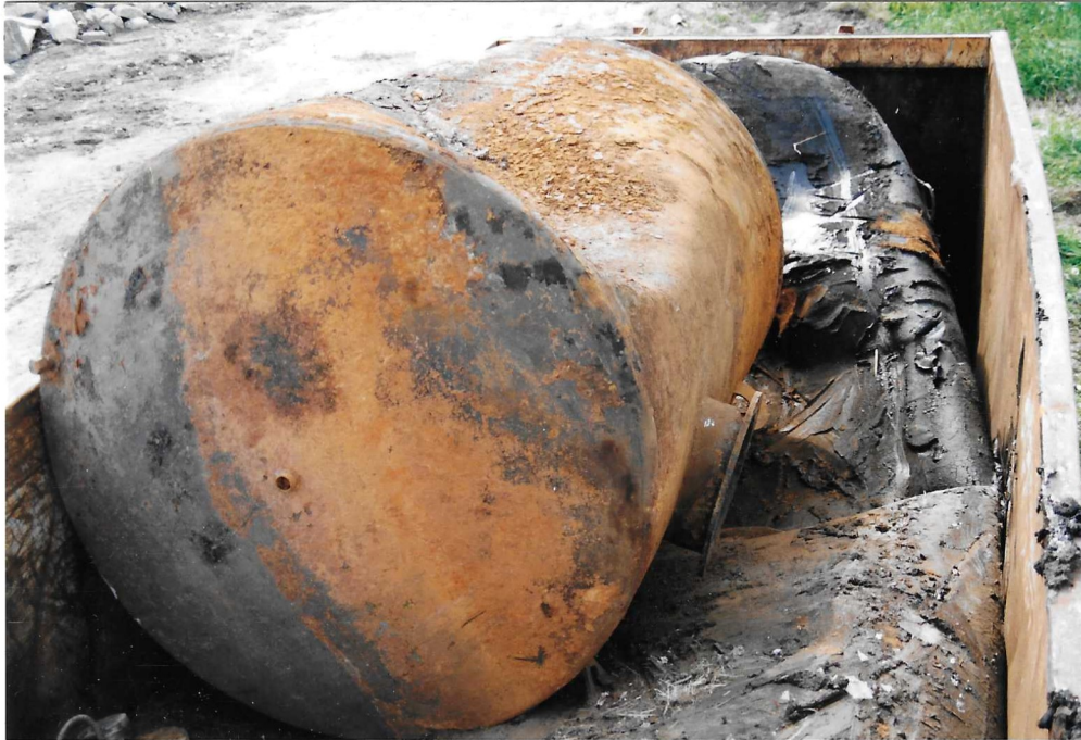
Foto 2: Tanks nach Ausbau – der Verlauf der Rostspuren zeigt, daß sich der Tank aus seiner Halterung gelöst hatte und längere Zeit kopfüber im Wasser schwamm
