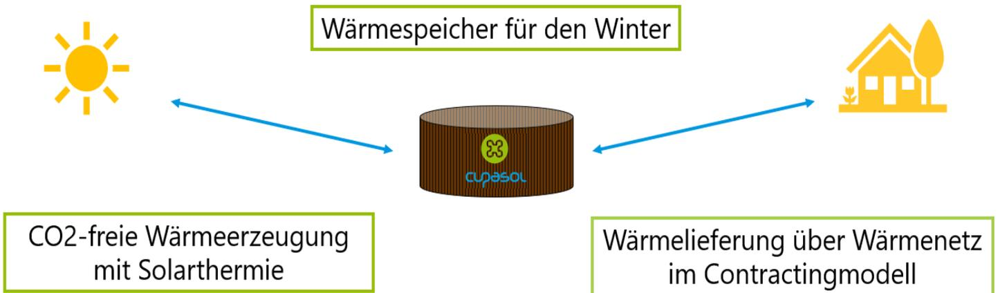
Mittels **Solarkollektoren** wird die Wärme für Raumheizung und Warmwasser direkt von der Sonne erzeugt. Über ein **Nahwärmenetz** wird die Wärme in Form von heißem Wasser an den Verbraucher geliefert. Für sonnenschwache Tage und den Winter wird überschüssige Wärme aus dem Sommer im **saisonalen Quartierswärmespeicher** eingespeichert und genutzt.
